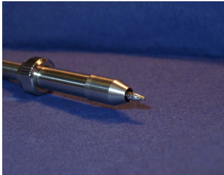
Figur 8. Ringdüse, Austrittsstelle für den Stickstoff
